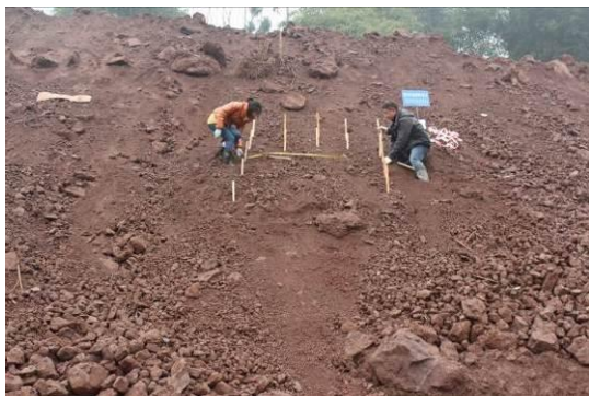
简易水土流失观测场制作及测量
