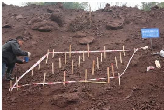
简易水土流失观测场制作及测量
